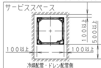
・室内ユニット据付時の障害物との距離は上図の通りに確保してください。
