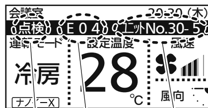
点検マーク 警報表示 不具合が発生している室内ユニットNo
