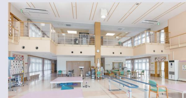
▲機能回復訓練室には2方向天井カセット形ナノイーX(48兆)搭載室内機と天井ビルトインカセット形室内機
